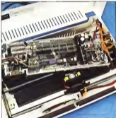
La piastrina dell'elettronica interna della macchina, collegata in basso al motore di avviamento di controllo e accesso ai microswitch per selezionare le varie funzioni.
